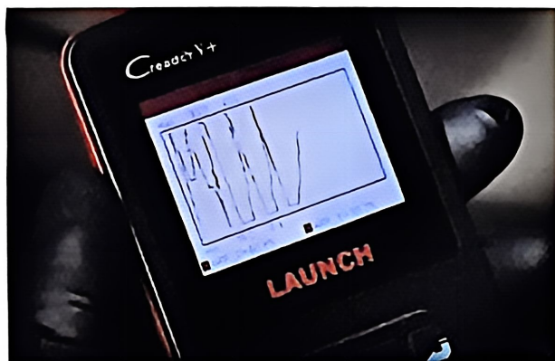
图 1-14 加速踏板位置传感器输出信号曲线的调取
