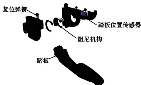
图 1-7 线控加速踏板的组成
