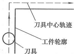
图1—59 刀具半径补偿功能
