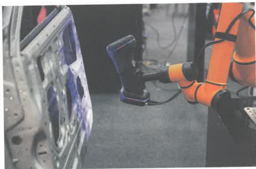
图 3-10 依托机器视觉技术的智能质量检测与控制设备
